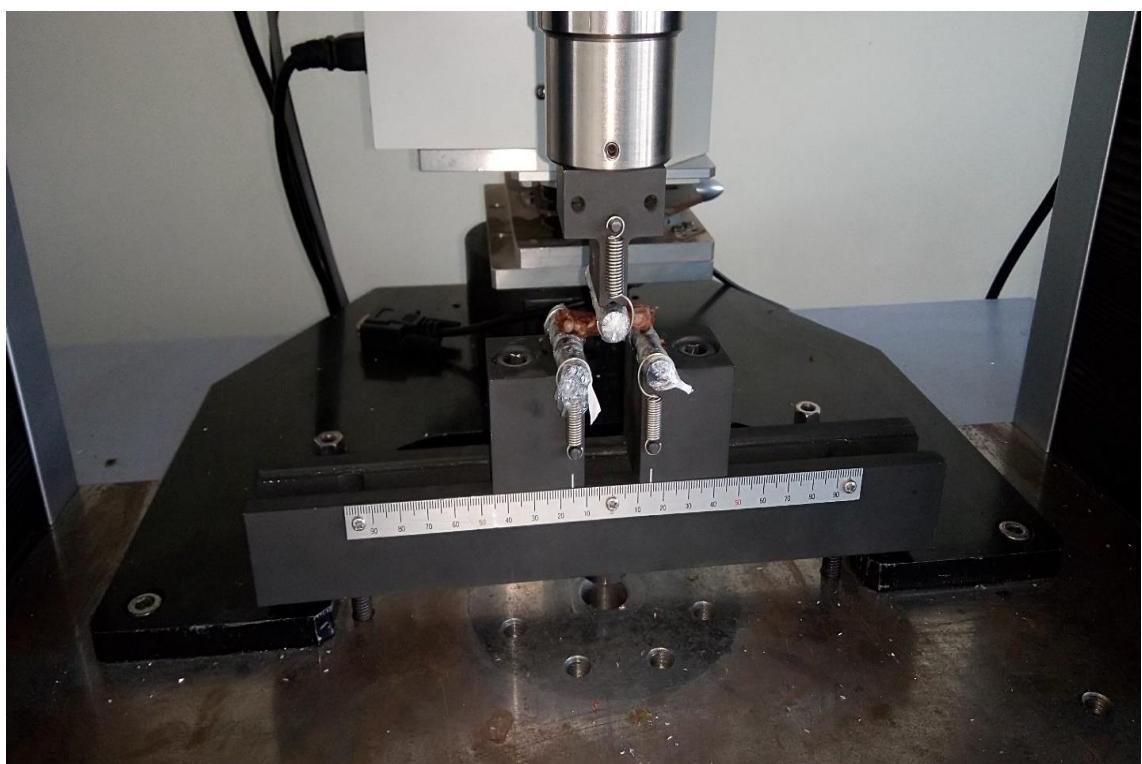
**Resim 6.** Üç nokta kırma (bending) testinin uygulanışı
