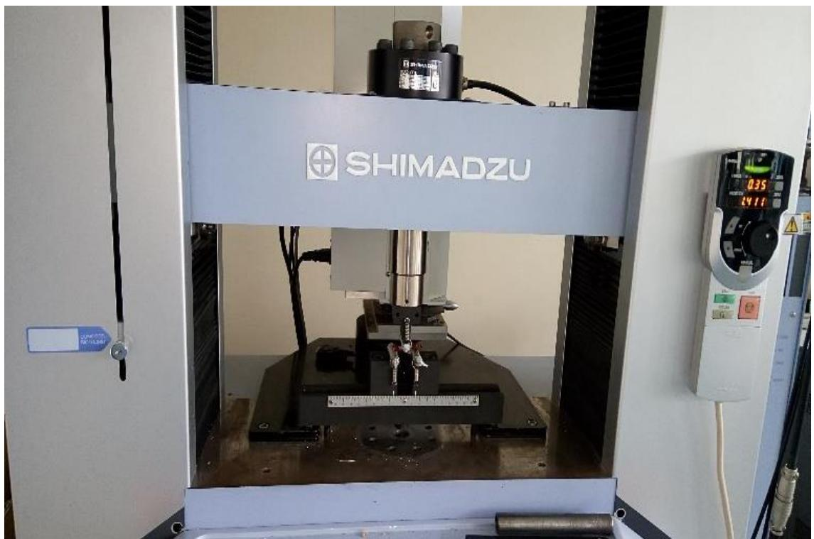
**Resim 5.** Biyomekanik çalışmada kullanılan 3 nokta eğme cihazı
